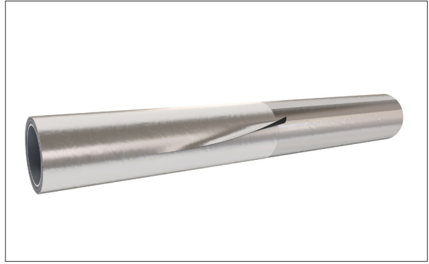
Рисунок 60: Нахлест паробарьера из фольги с бутилкаучуковой основой в области соединений, 50 мм
