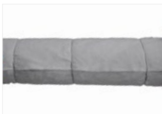
Рисунок 11. Продольный плотно прилегающий шов встык.
