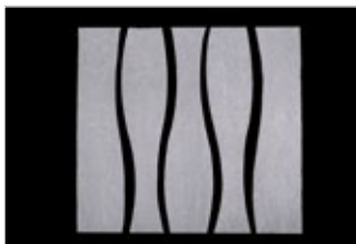
Рисунок 34. Вырежьте клиновидные сегменты в точности с окружностью трубы. Не забудьте про половину первой и последней части.
